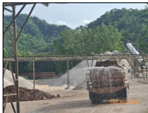
รูปที่ 2-12 การจัดเตรียมขนย้ายเศษดิน และเศษหิน ออกจากพื้นที่หน้าเหมือง และการจัดเตรียมรถฉีดพรมน้ำบริเวณที่มีกิจกรรมการขนย้าย
